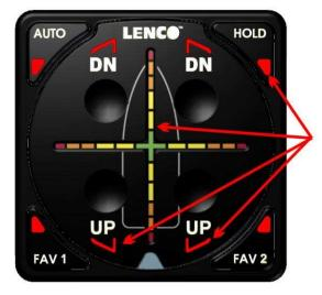
IF ENGINE AND GPS DATA IS REACQUIRED, THE KEY PAD WILL FLASH A <u>REACQUIRED DATA</u> <u>MESSAGE</u> INDICATING ALL OF THE REQUIRED INFORMATION IS BEING RECEIVED.
