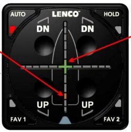
THE GREEN CENTER LED REMAINS ILLUMINATE TO INDICATE THAT THE BOAT'S <u>CURRENT ROLL POSITION</u> STILL MATCHES THE AUTO GLIDE'S <u>HOME ROLL DEFAULT POSITION</u>.
