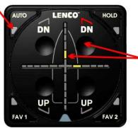
PRESS THE UP OR DN BUTTON ON THE KEY PAD TO CHANGE THE ROLL AND PITCH ANGLE OF THE BOAT.
