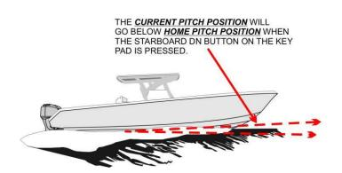
THE *CURRENT ROLL POSITION* WILL ALSO ROLL TO THE STARBOARD OF THE <u>HOME ROLL</u> <u>POSITION</u> WHEN THE STARBOARD DN BUTTON ON THE KEY PAD IS PRESSED.
